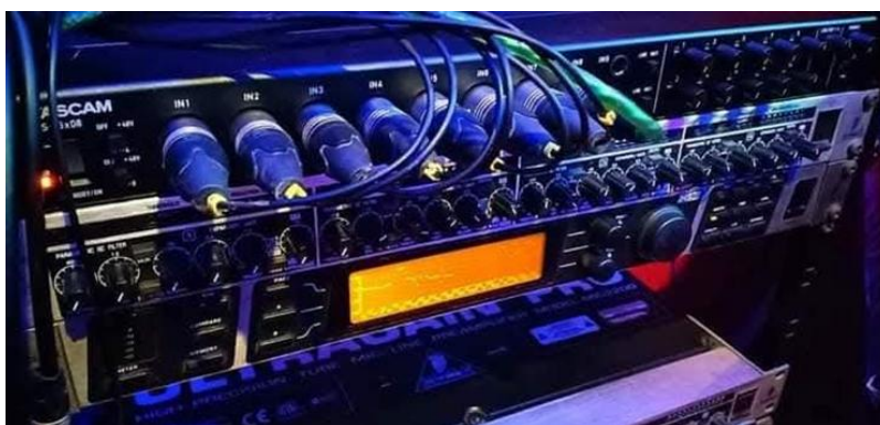
Gambar 3. Alat pengubah sinyal suara analog ke digital ( Audio Interface ) Tascam US-16x08 di Saverock Studio.
